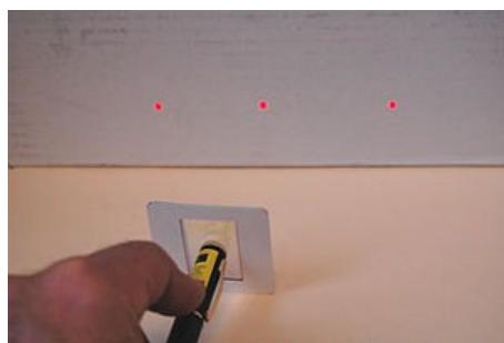
fig.32.3 Un esperimento di interferenza fatto con un laser a luce rossa
