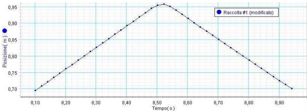
Il software che gestisce l'acquisizione è in grado di calcolare la pendenza dei due tratti rettilinei: + 0.66 m/s il tratto in salita, - 0.64 m/s quello in discesa.
